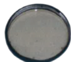
Colonies de moisissure développées, système ionair en fonctionnement
