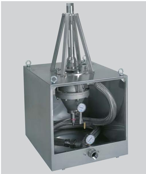
Das Herzstück des **AQUA HP-SYSTEMS** ist ein Reaktionsbehälter, der ähnlich einem Zyklon aufgebaut ist. Wasser wird, mittels einer Hochdruckpumpe, in den Reaktionsbehälter gedrückt und innerhalb einer Kammer derart beschleunigt, dass sehr hohe Strömungs- und Rotationsgeschwindigkeiten erzeugt werden. Der Volumenstrom wird so geführt, dass mehrere Wasserschichten, zentrifugal und zentripetal, gegeneinander reiben und große Scherkräfte entwickeln.
