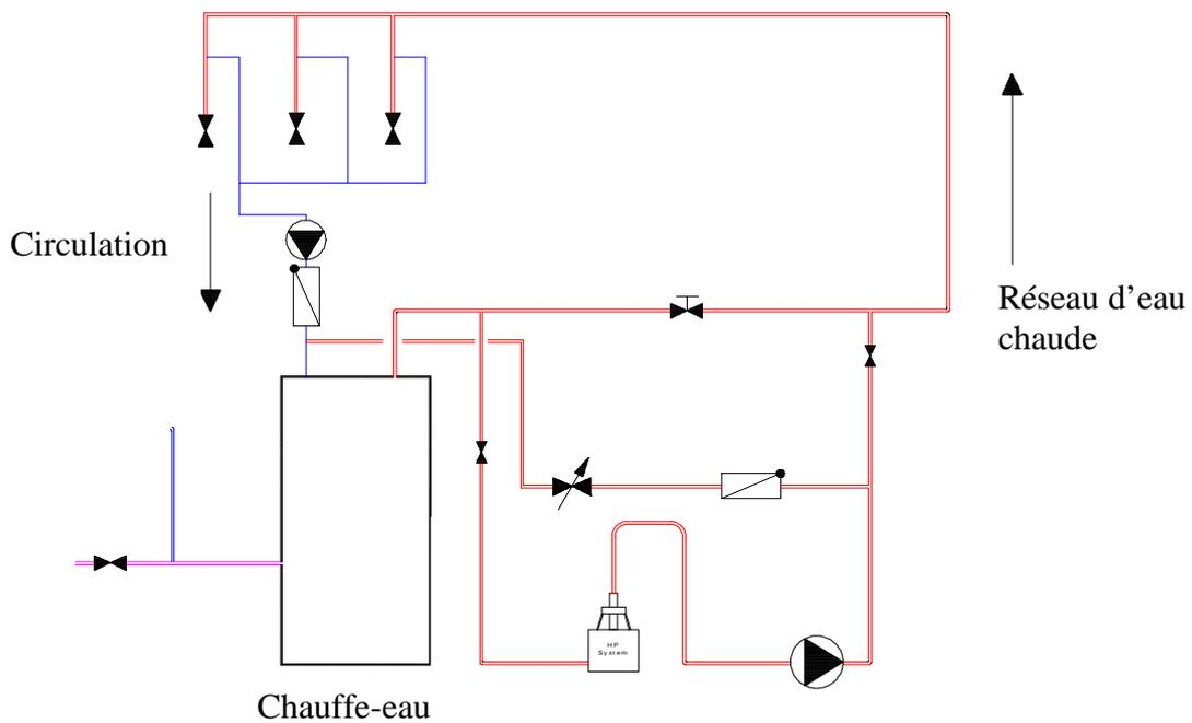
**Fig. 2** Installation dans le circuit d'adduction d'eau chaude avec intégration du chauffe-eau
