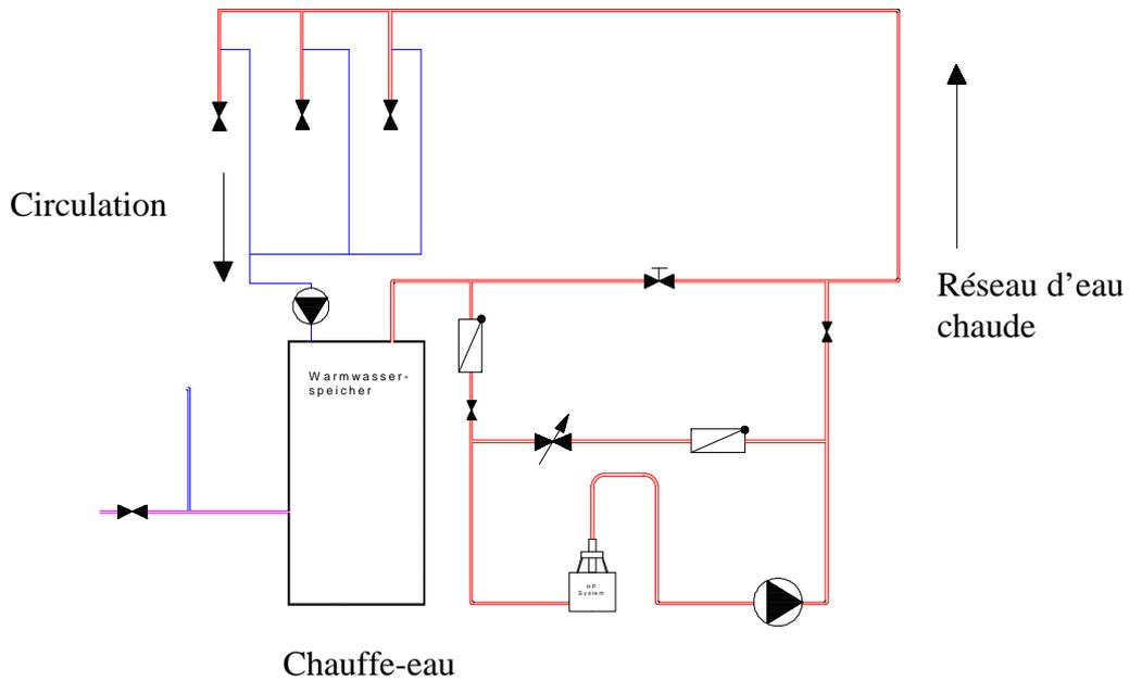
**Fig. 1** Installation dans le circuit d'adduction d'eau chaude
